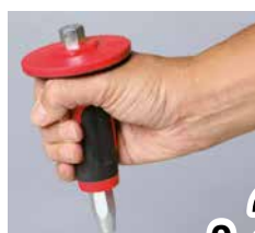
1462952 PERCUSSORE PER CHIODI Impugnatura ergonomica e protezione per la mano. Per il fissaggio dei condotti o le bande di fissaggio direttamente nel calcestruzzo. Speciale alloggiamento che impedisce al chiodo di cadere dal percussore
