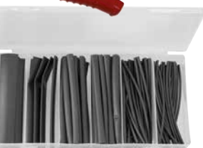
1462855 GUAINE TERMORESTRINGENTI 100PZ Lunghezza 100mm. Materiale autoestinguente VW-1. 6 misure (D/d in mm): 1,6/0,8-2,4/1,2-4,8/2,4-6,4/3,2-9,5/4,8-12,7/6,4. Rapporto di restringimento 2:1
